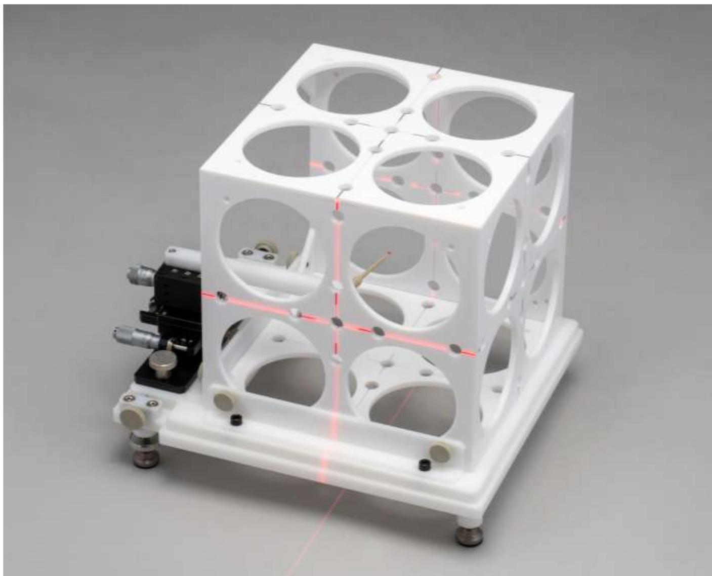
QCT-ビームアライメントツールは、加速器の幾何学的品質管理を効率的に行う検証ツールです。ビーム軸とアライメントの測定を簡単かつ高精度に実現します。
